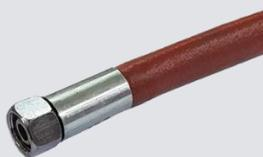
Flexible PTFE isolé (Flexible lisse avec gaine métallique et joint conique universel inox ; écrou et douille de sertissage en acier passivé à couche épaisse et scellé ; Pression de service 25 bar)
