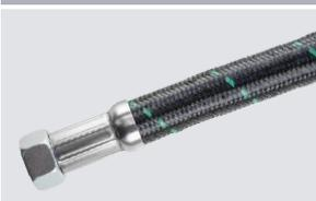
Flexible en PFA avec isolation intégrée (ondulé en parallèle avec triple isolation et cône d'étanchéité universel INOX ; pression de service 25 bar)
