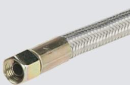
Flexible PTFE (Flexible lisse avec gaine métallique et joint conique universel inox ; écrou et douille de sertissage en acier passivé à couche épaisse et scellé ; Pression de service 25 bar)
