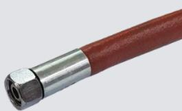
Schlauchleitung PFA isoliert (hochflexibler Wellschlauch mit Metallummantelung und Universal-Dichtkegel INOX; Mutter und Pressfassung Stahl dickschichtpassiviert und versiegelt; Betriebsdruck 25 bar)
