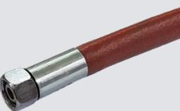
Schlauchleitung PTFE isoliert (Glattschlauch mit Metallummantelung und Universal-Dichtkegel INOX; Mutter und Pressfassung Stahl dickschichtpassiviert und versiegelt; Betriebsdruck 25 bar)
