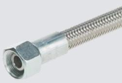
Schlauchleitung PFA (hochflexibler Wellschlauch mit Metallummantelung und Universal-Dichtkegel INOX; Mutter und Pressfassung Stahl dickschichtpassiviert und versiegelt; Betriebsdruck 25 bar)
